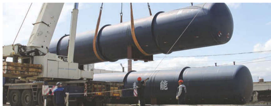
Разгрузка автоклавов для производства газосиликатных блоков, прибывших из Китая
